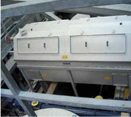
HUBER Bubanj Rešetka RoMesh® za uklanjanje sitnog i najfinijeg materijala.
