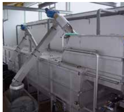
Potpuna mehanička obrada otpadnih voda u kompaktnoj, jedinstvenoj jedinici.
