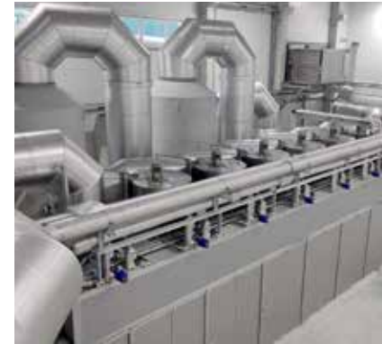
Sušenje mulja u industriji uz pomoć HUBER trakastog sušača BT.
