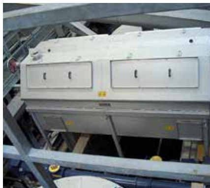
HUBER Bujanj rešetka RoMesh® rešetka za uklanjanje finih i najfinijih čestica.
