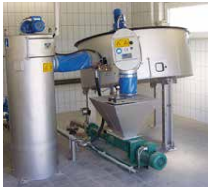
Jedinstveni zgušnjivač: HUBER Disk Zgušnjivač S-DISC.
