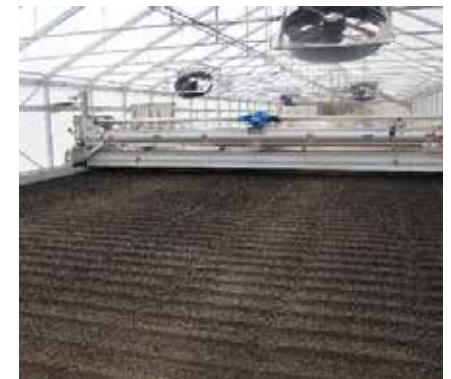
Dekanterisani komunalni mulj pretvara se u suvi, stabilan granulat mulja.
