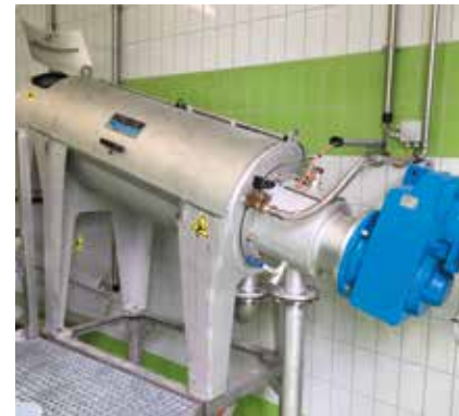
HUBER Pužna Presa Q-PRESS® za odvodnjavanje viška mulja u industriji mineralne vode / mešanih pića.
