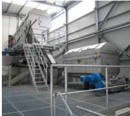
Potpuni sistem za tretman kanizacionog peska i otpada sa puteva.
