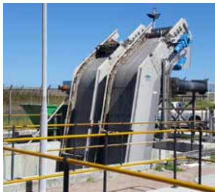
Robusna rešetka za uklanjanje grubog materijala: HUBER Gruba Rešetka TrashMax®.
