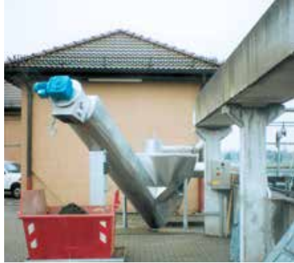
HUBER Coanda Klasifikacijski filter šljunka RoSF3.
