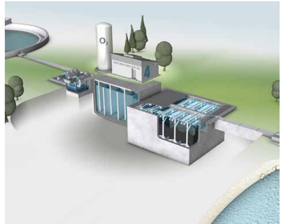
Napredni tretman otpadne vode za uklanjanje tragova supstanci koristeći kombinovani proces ozoniranja i nizvodni HUBER filter sa aktivnim ugljem CONTIFLOW® GAK.
