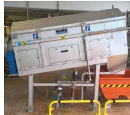
Pranje kontaminiranog šljunka s fleksibilnim bubnjem za pranje HUBER Wash Drum RoSF9.
